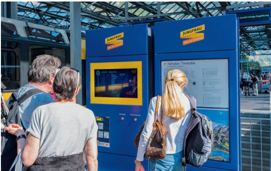
Abb. 3: Aktive Stele mit TFT-Display und Text-to-Speech, Jungfraubahnen
