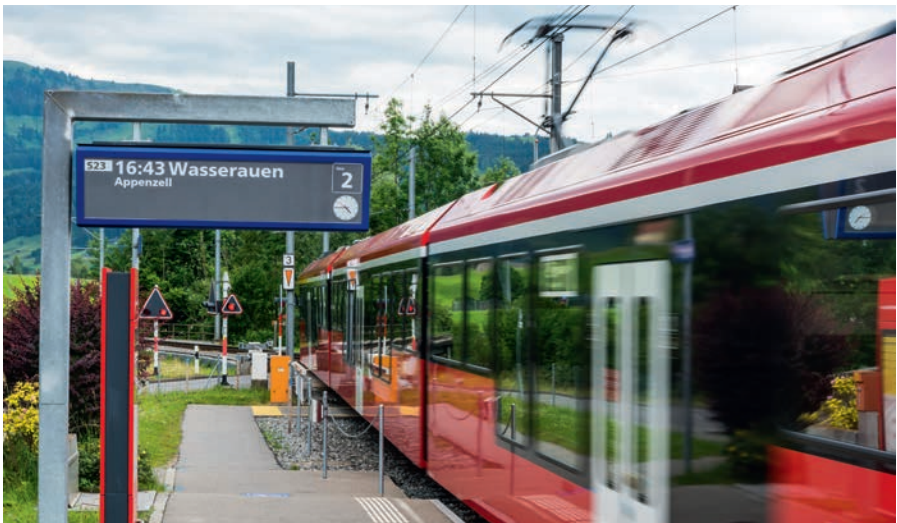
Abb. 1: Vollfarbiger, geneigter LED-Überkopfanzeiger, Appenzeller Bahnen AG
